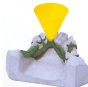
Рис. 2.2.2.б Множественная литниковая система
