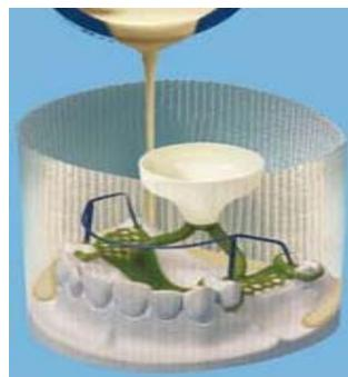
Рис. 2.2.3в Заполнение цилиндра паковочным материалом
