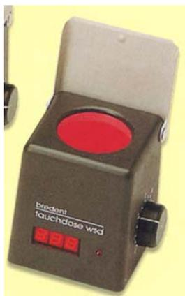
Рис. 4.1.6. Воскотопка может использоваться для моделирования корневой части штифта
