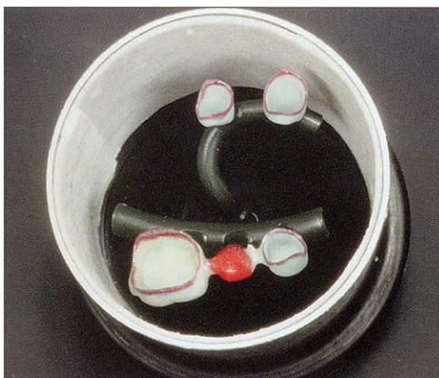
Рис.2.2.3.а Восковая конструкция с литниковой системой, расположенная на равномерном расстоянии от стенок цилиндра
